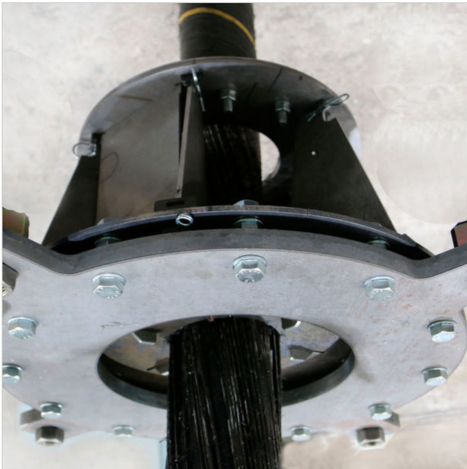
Das neue Hang Off von AMS kann Kabelgewichte bis etwa 5 t während der Montage und über die 25 Jahre Lebensdauer einer Windenergie-Anlage zuverlässig fixieren. (Walter Lutz)
